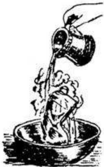
Hình 50. Đội nước lạnh vào bình sẽ làm nước ở trong bình sôi lên.
